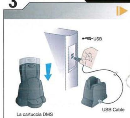
Collegate la base desktop al vostro PC tramite un cavo USB ed inserite la cartuccia DMS
